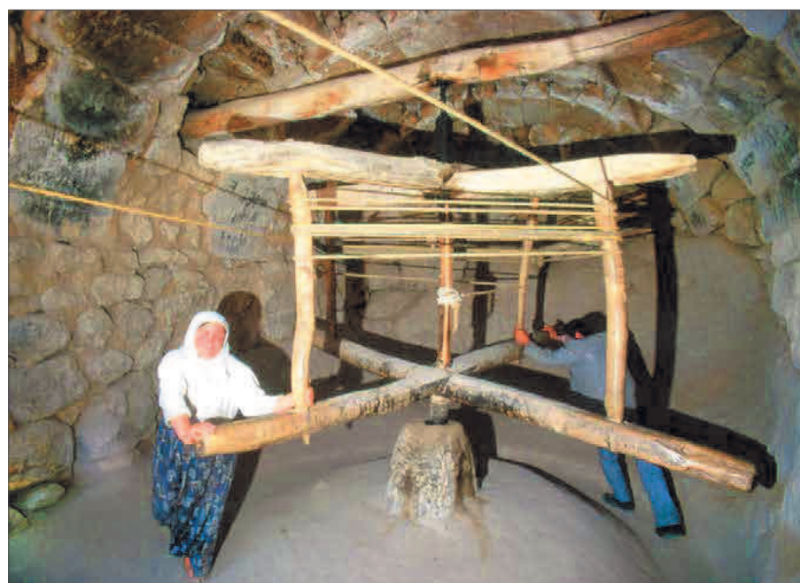
Figura 2 – Çekme, Derinkuyu (Cappadocia). Ruota per sollevare l'acqua di un pozzo collocato in un vano in muratura costruito in superficie (Foto M. Traverso)
